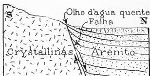
Fig. 40. — Secção mostrando a estrutura geologica no Brejo das Freiras, estado de Parahyba. (Waring.)
