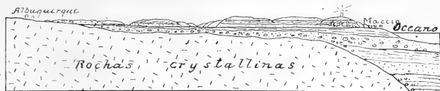
Fig. 165. — Secção mostrando a relação dos sedimentos terciários com as rochas crystallinas do interior em Maceió.
