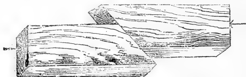
Fig. 110. — Blocos deslocados por um empurrão ilustrativo de uma falha revertida.
