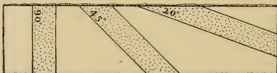
Fig. 97. — Camadas tendo a mesma espessura, porém inclinando-se em angulos differentes. Vê-se que a camada com a inclinação de 20 tem um afloramento que excede de duas vezes o da camada vertical da mesma espessura.
