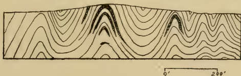
Fig 117. — Secção aavez dos vieiros sellados ( saddle reefs ) em Hargreaves, Nova Galles do Sul. As areas negras representam mineraes depositados em aberturas nas cristas dos anticlinos.
