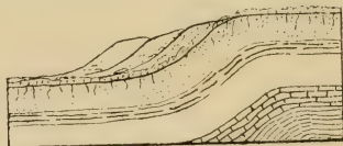
Fig. 93. — Secção mostrando a estrutura de um monoclimo.
