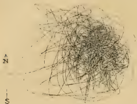
Fig. 41. — Registro de um seismographo mostrando os movimentos lateraes de um ponto sobre a superficie da terra durante um terremoto no Japão.
