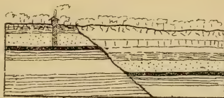
Fig. 112. — Seção mostrando o deslocamento de uma camada de carvão por uma falha normal.
